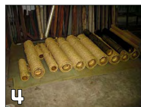
出来上がった手筒です この後、ひび割れの検査を行い、火薬詰を待ちます
